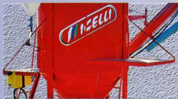
Plataforma para carga
