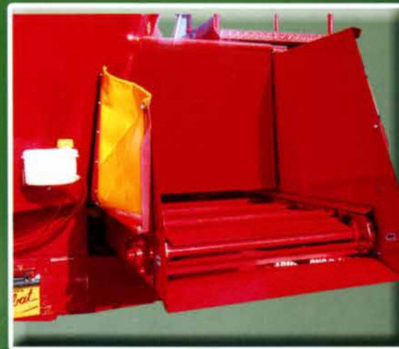
NORIA DE DESCARGA A CADENA CON BARROTES METALICOS ACCIONADA POR UN MOTOR HIDRÁULICO
