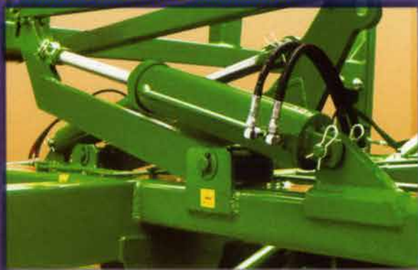
Plegado de alerones mediante 2 cilindros hidráulicos de 4"
